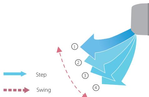
Il Flap motorizzato assicura la perfetta distribuzione dell'aria in ambiente sia in riscaldamento che in raffreddamento
