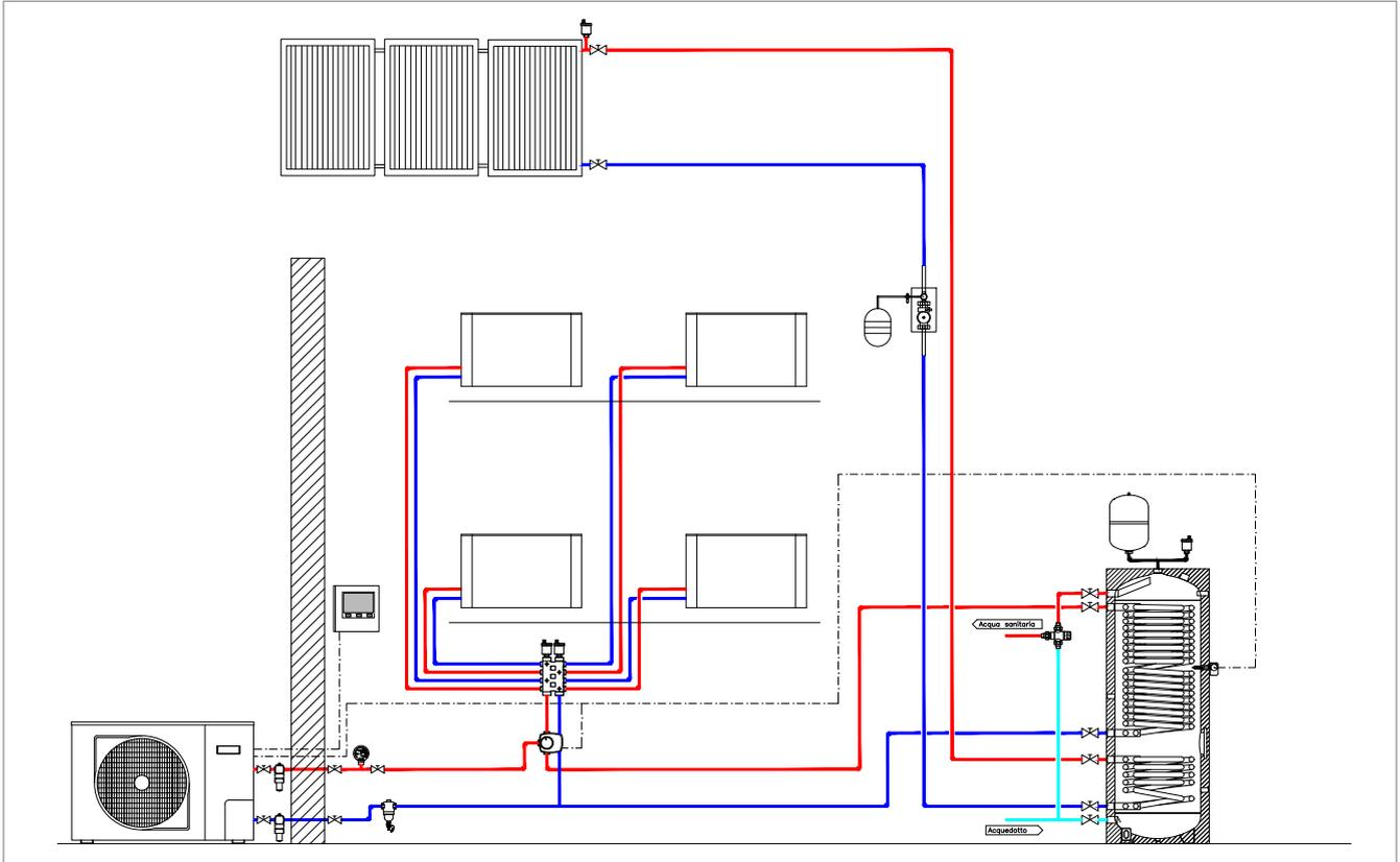
Pompa di calore SHERPA MONOBLOC (riscaldamento e condizionamento; produzione di ACS); terminali ventilradiatori Bi2 SLR; integrazione sanitario con solare termico e accumulo inerziale integrato per l'impianto di climatizzazione.
