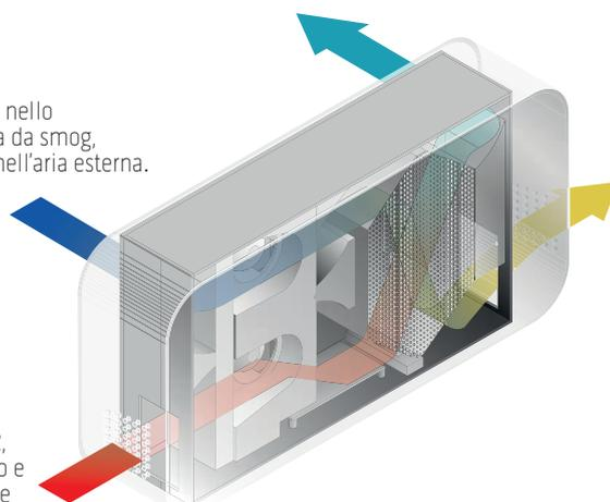
Lo scambiatore di calore riscalda l'aria pulita in entrata, recuperando fino all'86% del calore contenuto nell'aria esausta riscaldata dagli impianti.
