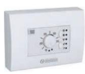
B0151<br><b>A ESAURIMENTO</b> | <b>Kit comando a parete</b> con termostato, selettore estate/inverno e selettore velocità.<br>Termostato a parete con sonda ambiente, selettore On-Off, selettore a tre velocità ventilatore e selettore estate/inverno. Campo di regolazione temperatura da 5°C a 30°C. Alimentazione a 230 V. Dispone di due uscite 230VAC elettrovalvola acqua calda ed elettrovalvola acqua fredda e di un ingresso sonda temperatura acqua.
