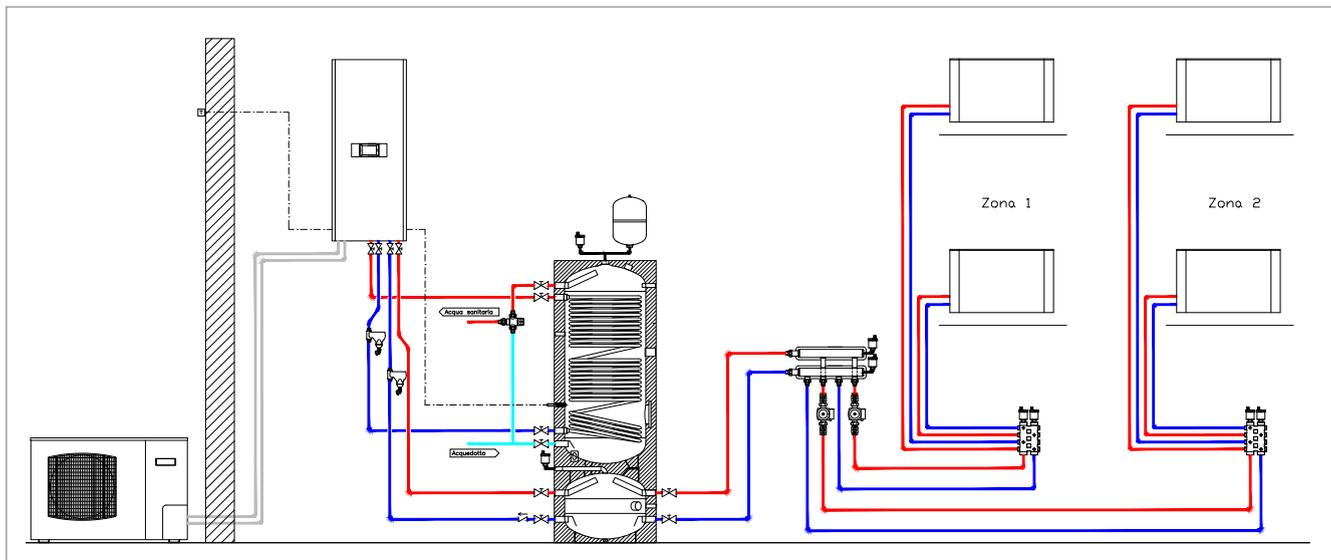
Pompa di calore SHERPA AQUADUE TOWER (riscaldamento e condizionamento; produzione di ACS ad alta temperatura); terminali ventilradiatori Bi2 SLR; esempio di schema a due zone con collettore
