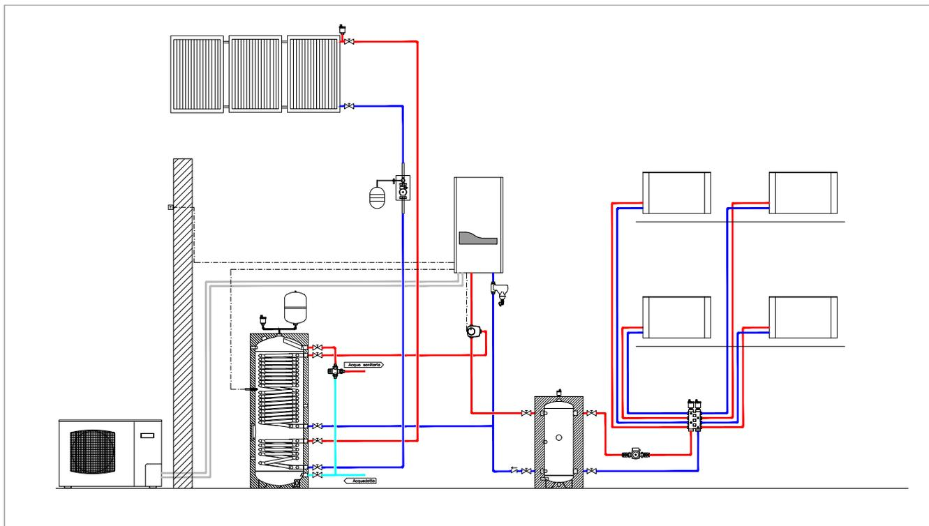
Pompa di calore SHERPA (riscaldamento e condizionamento; produzione di ACS); terminali ventilradiatori Bi2 SLR; integrazione sanitario con solare termico e accumulo inerziale integrato per l'impianto di climatizzazione.
