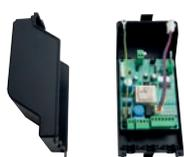
B0756                         | Kit comando <b>per remotizzazione</b> per la gestione e il controllo tramite ingresso analogico 0-10V o contatti. Dispone di un uscita a 230VAC per il controllo di un'elettrovalvola e di un ingresso sonda acqua con funzione sonda di minima (nella modalità a contatti).
