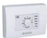
B0151<br>A ESAURIMENTO | <b>Kit comando a parete</b> con termostato, selettore estate/inverno e selettore velocità.<br>Termostato a parete con sonda ambiente, selettore On-Off, selettore a tre velocità ventilatore e selettore estate/inverno. Campo di regolazione temperatura da 5°C a 30°C. Alimentazione a 230 V. Dispone di due uscite 230VAC elettrovalvola acqua calda ed elettrovalvola acqua fredda e di un ingresso sonda temperatura acqua.
