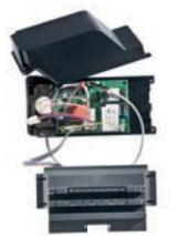
B0371<br>A ESAURIMENTO   | Kit comando elettronico <b>a bordo macchina</b> .<br>Comando con termostato ambiente regolabile, selezione modalità di funzionamento (ventilazione, estivo, invernale, automatico) e programma di ventilazione (minimo, massimo, notturno, modulato), funzione sonda di minima acqua. Dispone di un ingresso per collegamento contatto sensore presenza, di una uscita a 230VAC per controllo elettrovalvola, di contatti per abilitazione boiler o chiller.
