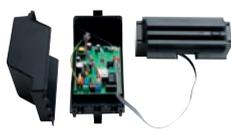
B0685<br><b>A ESAURIMENTO</b>  | Kit comando Bi2 Inverter <b>per remotizzazione</b> .<br>I principali parametri operativi, il set point e la temperatura ambiente, vengono trasmessi dal controllo remoto B0736 a tutti i fancoil connessi in rete, consentendo un funzionamento omogeneo. Dispone di un'uscita a 230VAC per il controllo di un'elettrovalvola, di due contatti puliti per il comando boiler o chiller e di un ingresso presenza.<br>Funzionamento in protocollo MODBUS, RS485.
