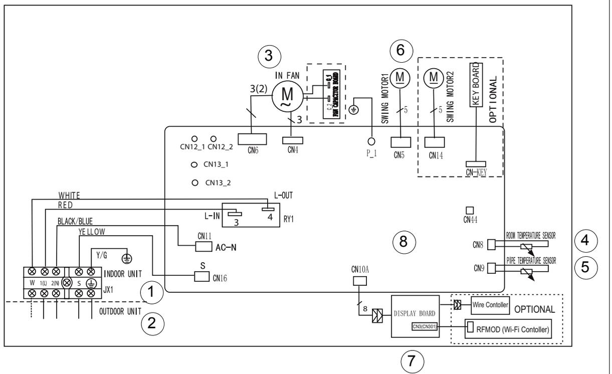
**ESQUEMA ELÉCTRICO DE LA UNIDAD INTERIOR MODELO 9-10 Y 12 (fig. 55)**
