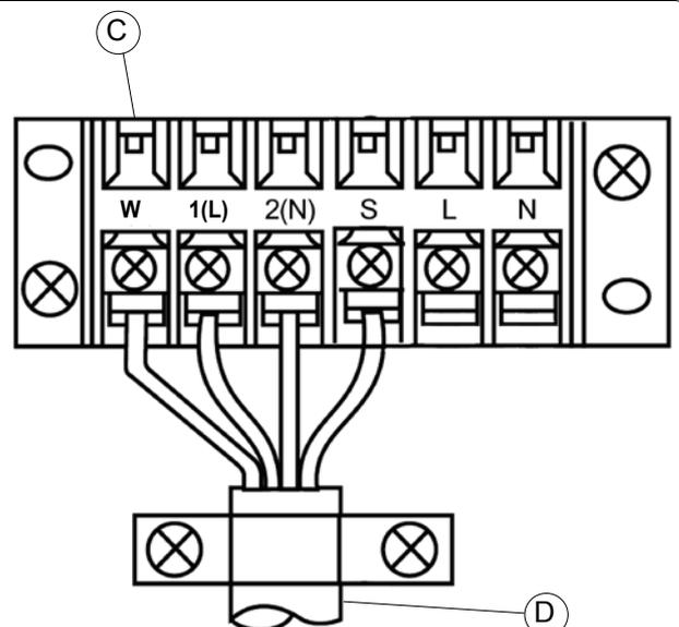
**Conexión del cable a la unidad exterior (fig. 30)**
