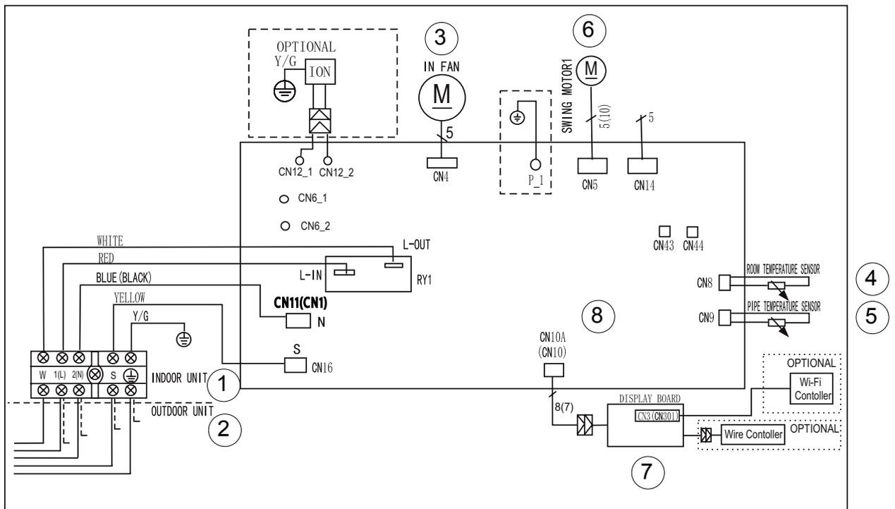
**ESQUEMA ELÉCTRICO DE LA UNIDAD INTERIOR MODELO 18 Y 24 (fig. 57)**
