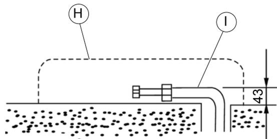
**Tubo de conexión (fig. 7a)**
